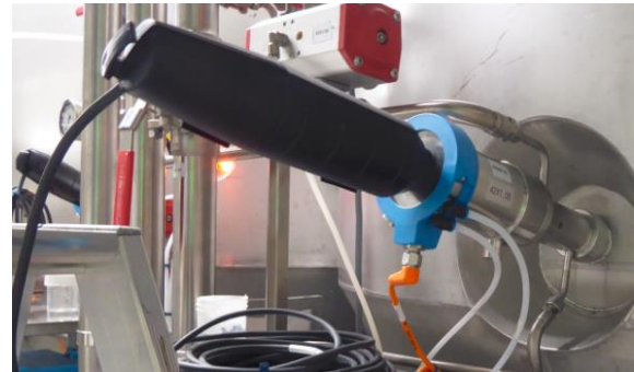
Abb. 16: Wechselarmaturen der pH-Sonde; links Ausgebaute pH-Sonde, Serviceposition – Abb. 17: Rechts: eingebaute pH-Sonde, Messposition
