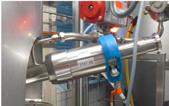
Abb. 16: Wechselarmaturen der pH-Sonde; links Ausgebaute pH-Sonde, Serviceposition – Abb. 17: Rechts: eingebaute pH-Sonde, Messposition
